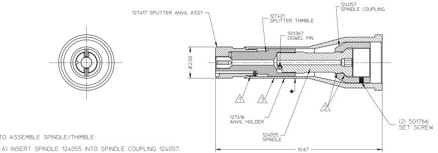
TO ASSEMBLE SPINDLE/THIMBLE:
